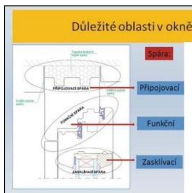
Obr. 5.1 Spáry v okně (zdroj http://www.tzb-info.cz , článek Okna a dveře – funkční spára a její vliv na funkčnost otvorové výplně
